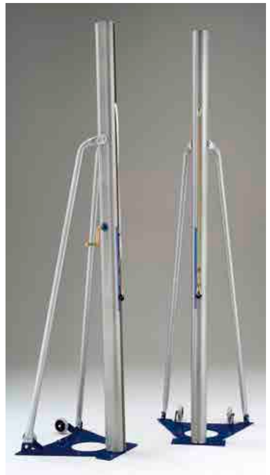
Art. V5029 Impianto pallavolo a tiranti ridotti in lega di alluminio profilo sezione mm. 120x100 con ruote per il trasporto piastra anti torsione alla base, arganello tendirete autofrenante senza cremagliera anti infortunistico Volleyball posts in aluminium transportable with wheels, pipe section 120x100 mm.
