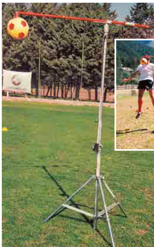
Art. HJT Head Jump Tester Strumento polivalente di misurazione e allenamento, permette la valutazione delle qualità muscolari degli arti inferiori, dell'elevazione dei giocatori, del loro modo di colpire la palla di testa e dell'ampiezza del tuffo del portiere Instrument that allows the training and measurement of jump ability of players and goal-keepers
